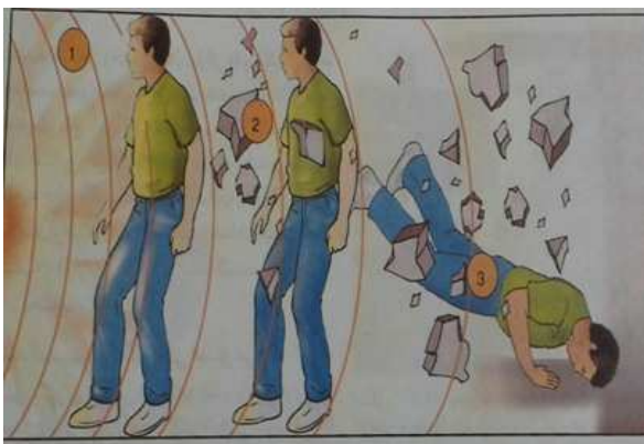
شکل ۳۴- ۶: صدمات ناشی از موج انفجار، فاز ۱: موج ناشی از انفجار به مصدوم می رسد. فاز ۲: ترکش های ناشی از انفجار تبدیل به پرتابه شده و موجب آسیب می شوند. فاز ۳: فرد مصدوم خود تبدیل به پرتابه شده و با اجسام دیگر یا زمین برخورد می کند. Source : PHTLS 2015
